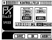
Dadurch wird nicht die Geschwindigkeit des ganzen Systems verdoppelt, da bei jedem Speicher-, bzw. Peripheriezugriff die CPU wieder langsamer geschaltet wird. Also gilt der hohe Takt nur dann, wenn der Prozessor gerade Daten aus seinem internen Cache verarbeitet. Dieser interne Cache des 68030 besteht aus je 256 Bytes für Code und Daten und wirkt nur für Lese-Zugriffe.
