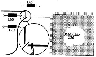
Löten Sie dann ein ca. 25cm langes Litzenstück an die Leiterbahn bei U36 (vorher den Lötstoplack etwas von der Kupferbahn kratzen).
