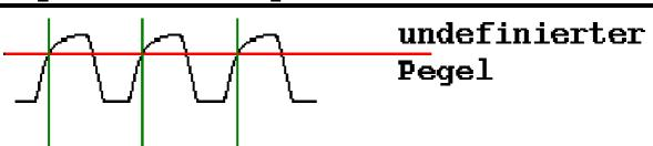
Abtastsignale vom Prozessor Nach einigen Versuchen haben wir nun endlich eine Lösung für das HSS-Problem gefunden. Es ist lediglich erforderlich die Verstsärkung der Eingangsstufe heraufzusetzen. Hierzu muß nur der Vorwiderstand in der "DATA IN" Leitung niederohmiger gemacht werden.
