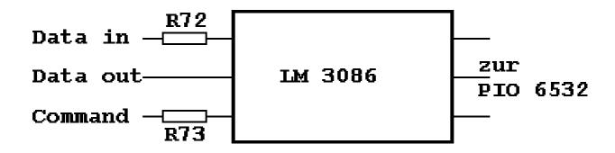
Tests mit mehreren Laufwerken haben ergeben, daß eine Änderung des Widerstandes R72 von 100 kOhm auf 50 kOhm den gewünschten Erfolg bringt. Sie können den Ursprünglichen Widerstand gegen einen neuen 47 kOhm Widerstand ersetzen oder einfach einen zusätzlichen 100 kOhm Widerstand parallel zu dem bereits vorhandenen R72 löten.
