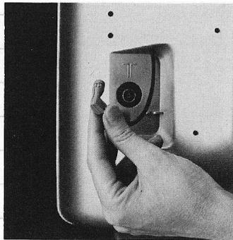
Die Fernsehantenne von der Antennensteckdose hinten am Fernsehgerät entkoppeln.
