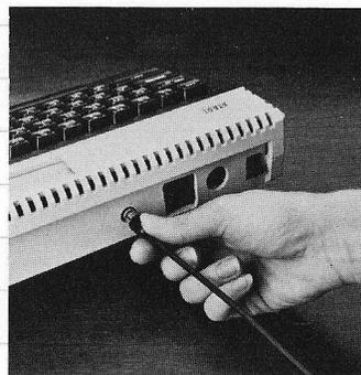
Ein Ende des RF-Kabels an die als "television" beschriftete Steckdose hinten am Fernsehgerät anschliessen.
