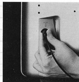
Das andere Ende des RF-Kabels an die Antennensteckdose hinten am Fernsehgerät anschliessen.
