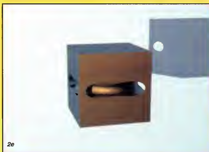
Operacje na obiektach CSG: a) figura A, b) figura B, c) złączenie (A+B), d) część wspólna (A*B), e) różnica (A-B), f) różnica (B-A).
