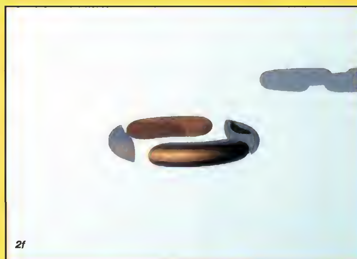
Operacje na obiektach CSG: a) figura A, b) figura B, c) złączenie (A+B), d) część wspólna (A*B), e) różnica (A-B), f) różnica (B-A).
