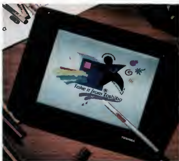
Toshiba Dynapad T200, przedstawiciel „rysikowców” (i486DX2 40 MHz, HD 80 MB, 4 MB RAM, 2xPCMCIA, ekran kolorowy)
