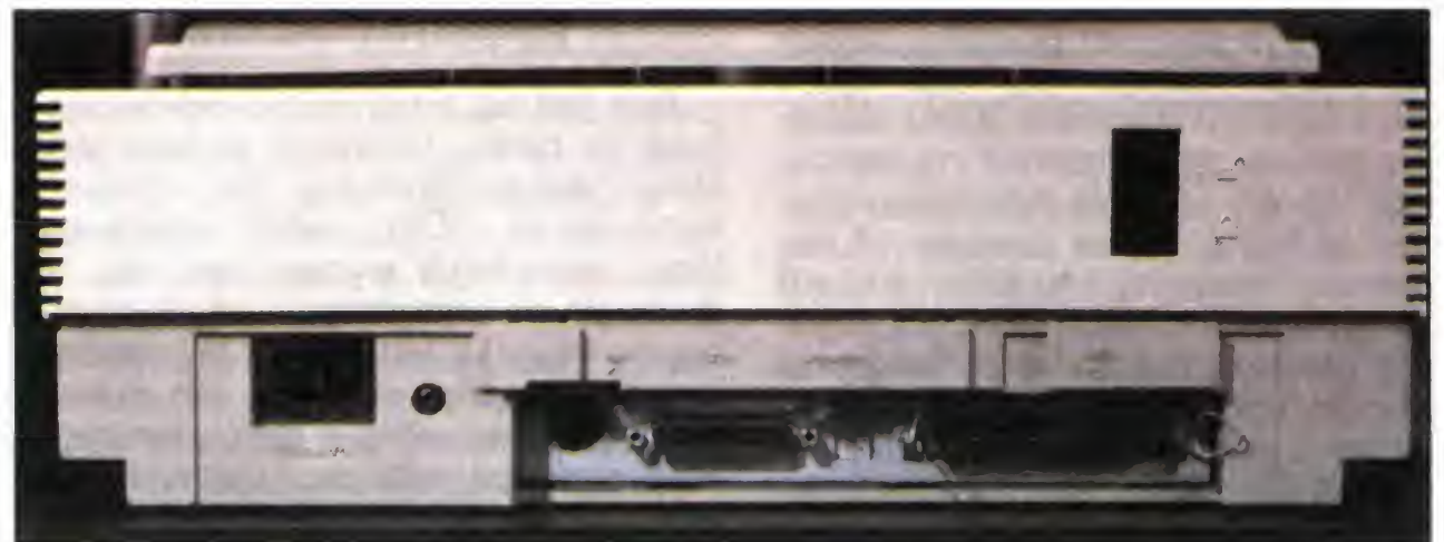
Tylna ścianka skanera. Z prawej strony u góry widać blokadę transportową. Dwa duże gniazda to wejście i wyjście interfejsu SCSI, zatem do skanera można podłączać dalsze, dodatkowe urządzenia, na przykład drukarkę lub drugi skaner.
