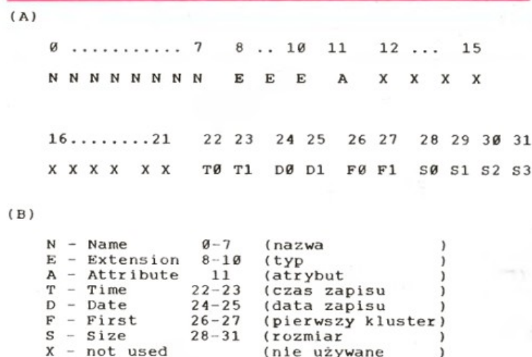
Rys. 4. Pozycja katalogu (ang. directory entry) opisująca plik dla dyskiety MS-DOS'u.
