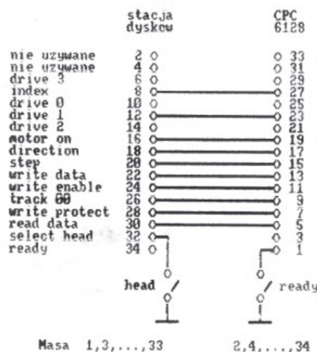
Rys. 1 — Połączenie między stacją dysków a komputerem Amstrad CPC 6128
